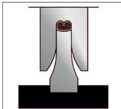
Die Endstellung bei vorgegebener Crimphöhe garantiert die notwendige Verpressung des Leiters zu einem dichten Crimp.
