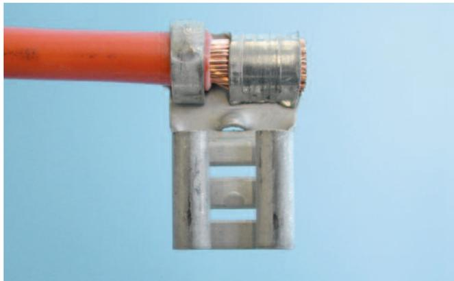
Der Tab-Lok-Crimp wird hauptsächlich bei engen Platzverhältnissen eingesetzt. Beim Crimpen wird eine Zunge am Ende der einseitigen Leitercrimphülse durch einen Schlitz im Kontaktboden geführt, abgewinkelt und mit zwei Rastnasen auf der Unterseite arretiert.
