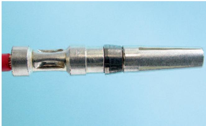
*Der Indent-Crimp wird bei gedrehten Kontakten angewendet.*
