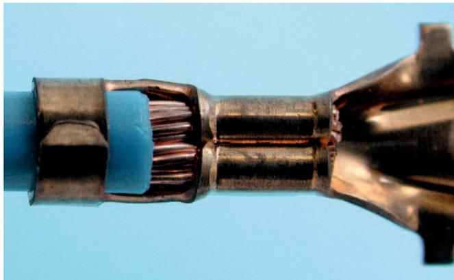
*Der Überlappungscrimp wird hauptsächlich bei Leitungen mit dünnwandiger Isolierung eingesetzt. Die übereinander liegenden Crimp-Flanken drücken flächig auf die Leitung und halten diese fest.*
