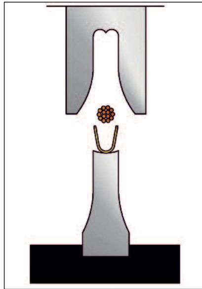
Das Verarbeitungs-Werkzeug ist geöffnet. Auf dem Amboss ist ein Kontakt positioniert. Die Leitung wird von Hand oder maschinell eingelegt.
