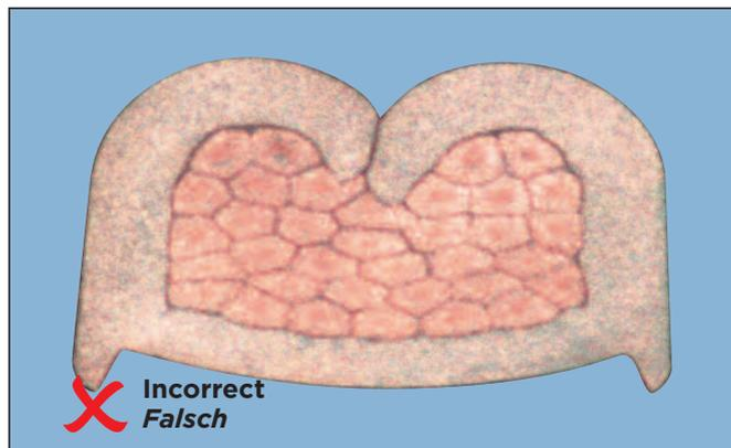
Starke Überpressung mit nicht mehr zulässiger Gratbildung am Crimpboden. Schwächung der mechanischen Haltekraft der Crimphülse und Erhöhung des Crimp-Übergangswiderstandes infolge Querschnittsreduzierung des Leiters. Erhöhter Werkzeugverschleiß.
