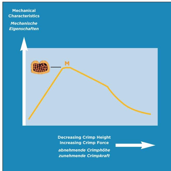
Die erste Graphik zeigt qualitativ die Veränderung der mechanischen Eigenschaften, d.h. der Zugfestigkeit der Verbindung zwischen Leiter und Crimphülse in Abhängigkeit von der Crimphöhe.
