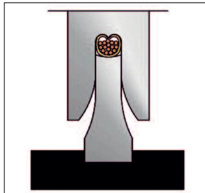
Im weiteren Ablauf werden die Crimpflanken eingerollt, der Leiter gleichmäßig verdichtet und der Crimp geformt.
