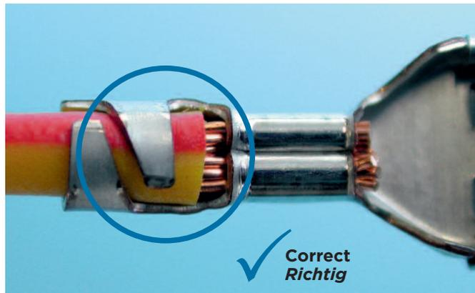
Für einen weichen Übergang des Leiters von der verpressten Zone in den ursprünglichen Querschnitt ist am Ende der Leitercrimp-hülse ein glockenförmiger Auslauf (Bellmouth) vorgeschrieben.
