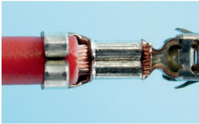
*Der F-Crimp wird allgemein bei Leitungen mit dickwandiger Isolierung eingesetzt. Die eingerollten Crimp-Flanken stoßen mit den Spitzen in die Isolation hinein.*
