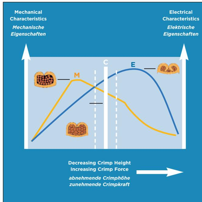
Die von TE Connectivity festgelegte Crimphöhe C mit beidseitigen Toleranzbereich stellt einen Kompromiss zwischen dem mechanischen und elektrischen Optimum dar.
